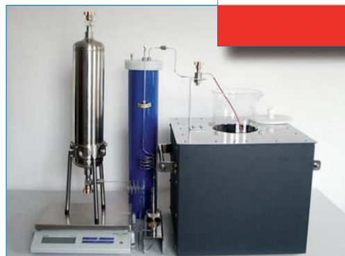
Stanowisko do badania pozostałości olejowej w LPG wg PN EN ISO 13575
