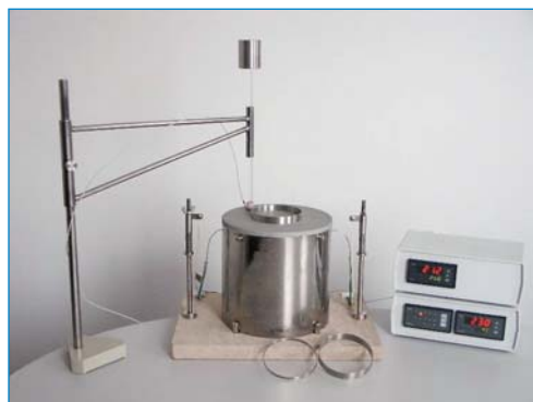
Stanowisko do oznaczania minimalnej temperatury zapłonu pyłu wg PN-EN 50281
