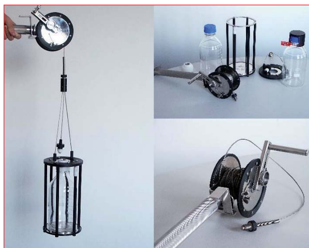
Zestawy do ręcznego pobierania paliw wg PN-EN ISO 3170
