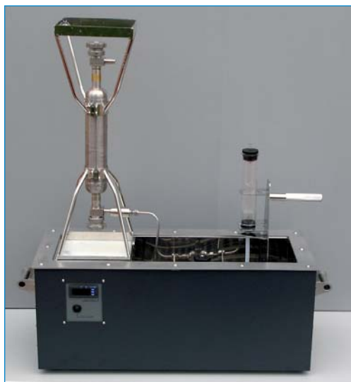
Aparat do oznaczania siarkowodoru w LPG wg PN-EN ISO 8819
