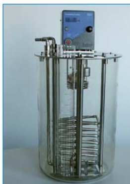
Łaźnia do oznaczania zdolności do pienienia wg ASTM D 892
