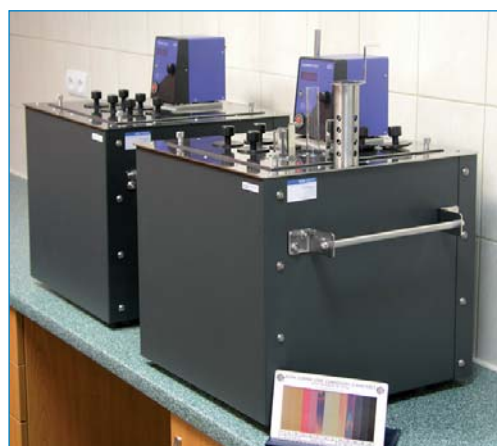
Łaźnie z wymiennymi pokrywami m.in do testów korozji wg norm PN EN ISO 2160, PN EN ISO 6251 i odporności na utlenianie PN-ISO 12205
