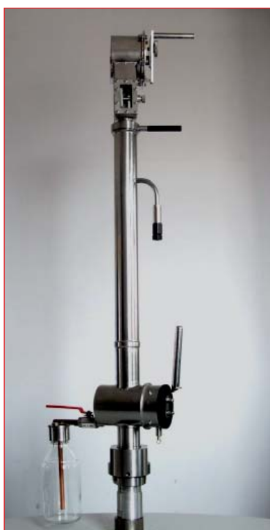
Zestawy do ręcznego pobierania paliw wg PN-EN ISO 3170
